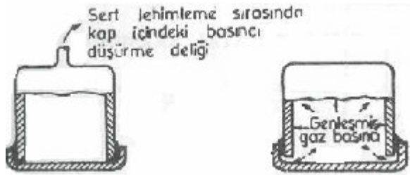
Şek.108. – Sert lehimlemede havanın alınması
