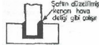
Şek.109.- Sert lehimlemede kör deliklerin havasının alınması
