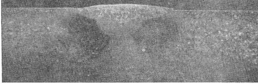
Şek. 19 - 12 mm kalınlıkta bir kaynak edilebilir özel I beyaz temper dökümünün elektrik ark kaynağı birleşmesinin kesiti (x3)
