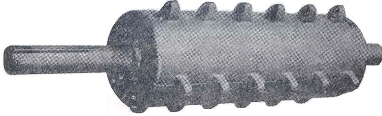
Şek. 3 - 45010 kalitesinde perlitik temperden zincir tahriki için dişli merdane, yüksek mukavemetli mil üstüne kaynak edilmiş. Yüksek nikelli elektrod.
