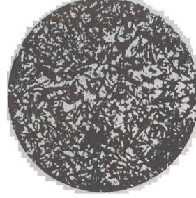
Şek. 75.- Püskürtülmüş %0,8 karbonlu çeliğin martensitik içyapısı
