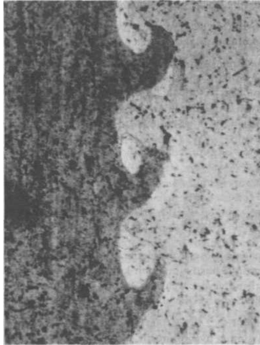
Şekil: 220 — Bir patlama kaynağının mikrofotografı. Dalgacıkları haiz yüzeyarası görülür.
