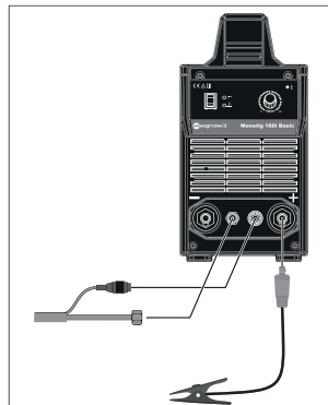
Рисунок 4 : Соединения для сварки TIG
