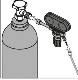
Şekil 4 : Gaz Tüpü Bağlantısı
