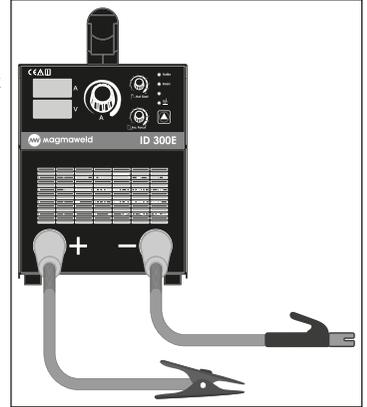
Şekil 3 : Örtülü Elektrod Kaynağı Bağlantıları
