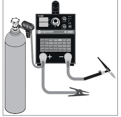
Şekil 5 : TIG Kaynağı Bağlantısı
