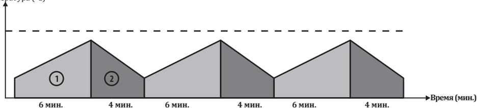
Согласно стандарту EN 60974-1, продолжительность рабочего цикла включает период времени 10 минут. Например, если машина, указанная как 250А при% 60, должна работать при 250А, машина может выполнять сварку / резку без перерыва в первые 6 минут из 10-минутного периода (зона 1). Однако следующие Для охлаждения машины необходимо 4 минуты простоя (зона 2).
