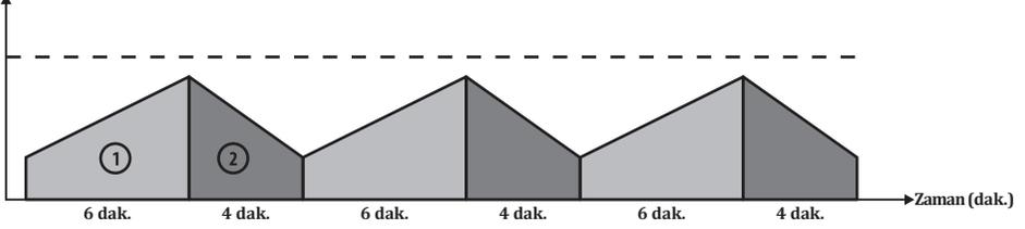
EN 60974-1 standardında da tanımlandığı üzere çalışma çevrim oranı 10 dakikalık bir zaman periyodunu içerir. Örnek olarak %60'da 250A olarak belirtilen bir makinede 250A'de çalışılmak isteniyorsa, makine 10 dakikalık zaman periyodunun ilk 6 dakikasında hiç durmadan kaynak yapabilir (1 bölgesi). Ancak bunu takip eden 4 dakika makine soğuması için boşta bekletilmelidir (2 bölgesi).
