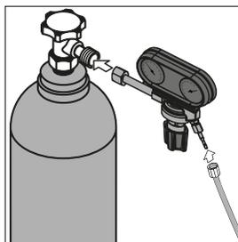
Figure 4 : Connexion de la bouteille de gaz
