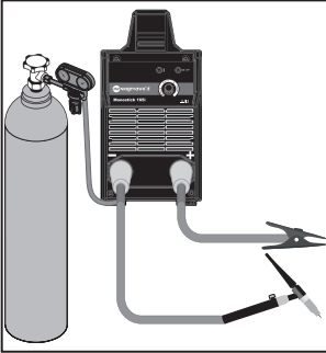
Şekil 3 : TIG Kaynağı Bağlantıları
